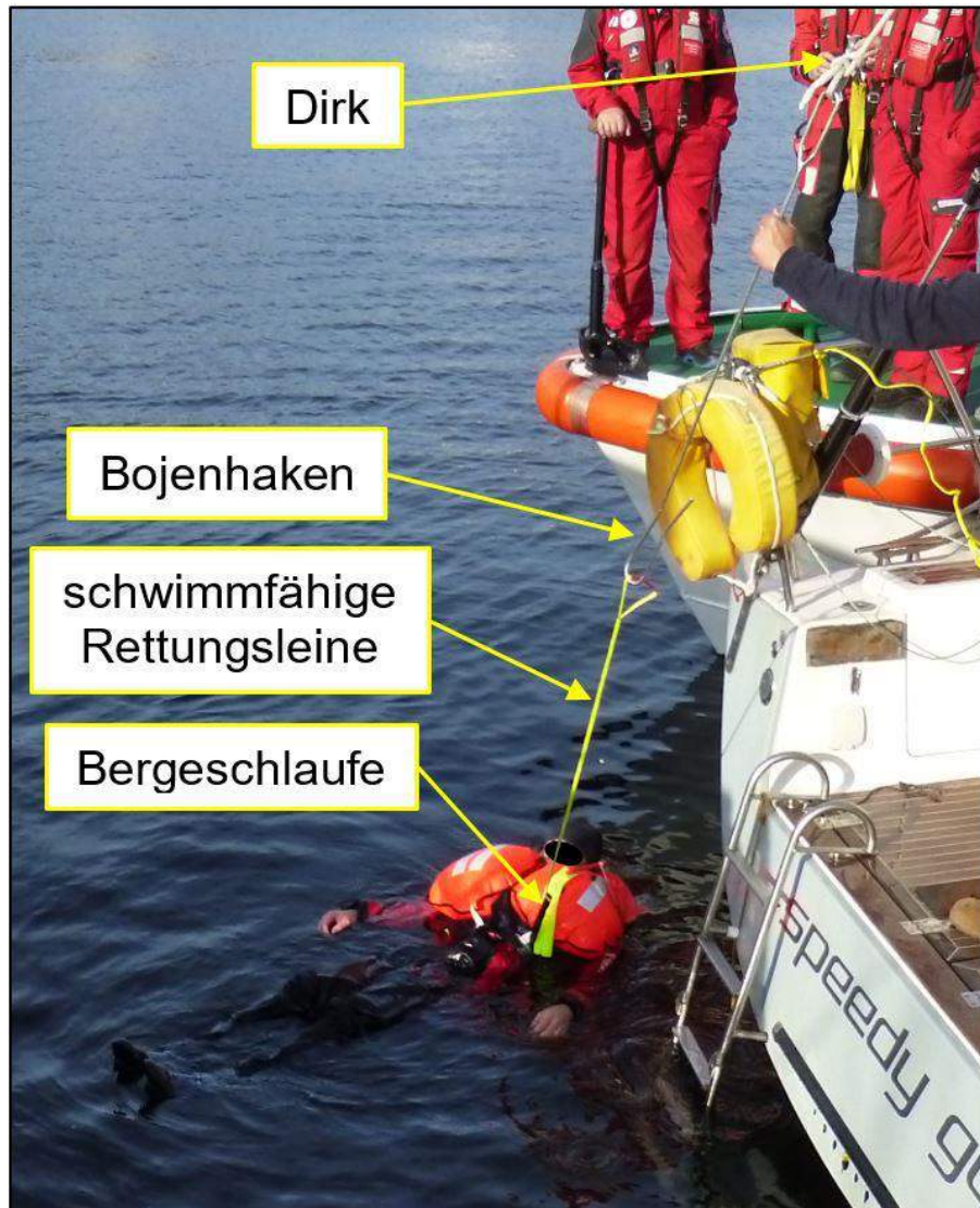
Abbildung 27: Rettung mittels an der Dirk befestigtem Bojenhaken 101
