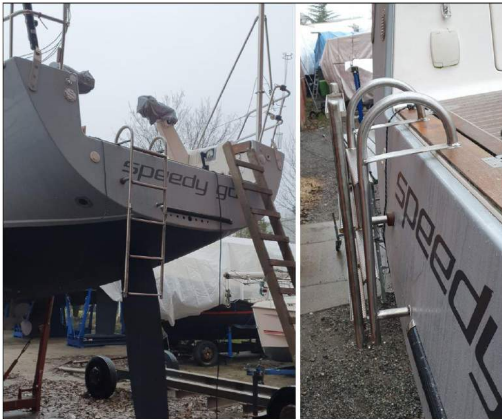
Abbildung 40: Festmontierte Badeleiter der SPEEDY GO nach Umbau 135
