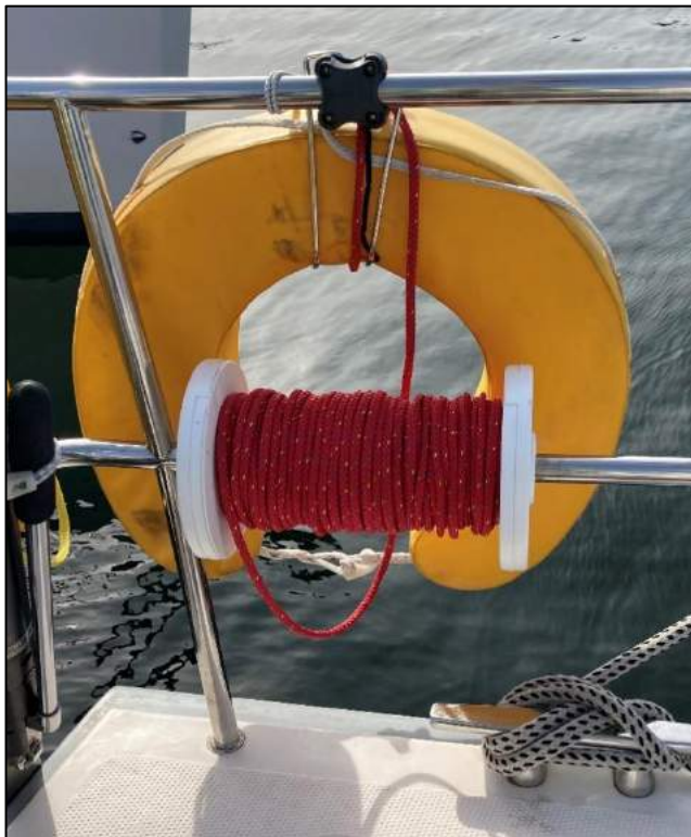
Abbildung 8: Backbordseitiger Hufeisen-Rettungsring mit Leine 28
